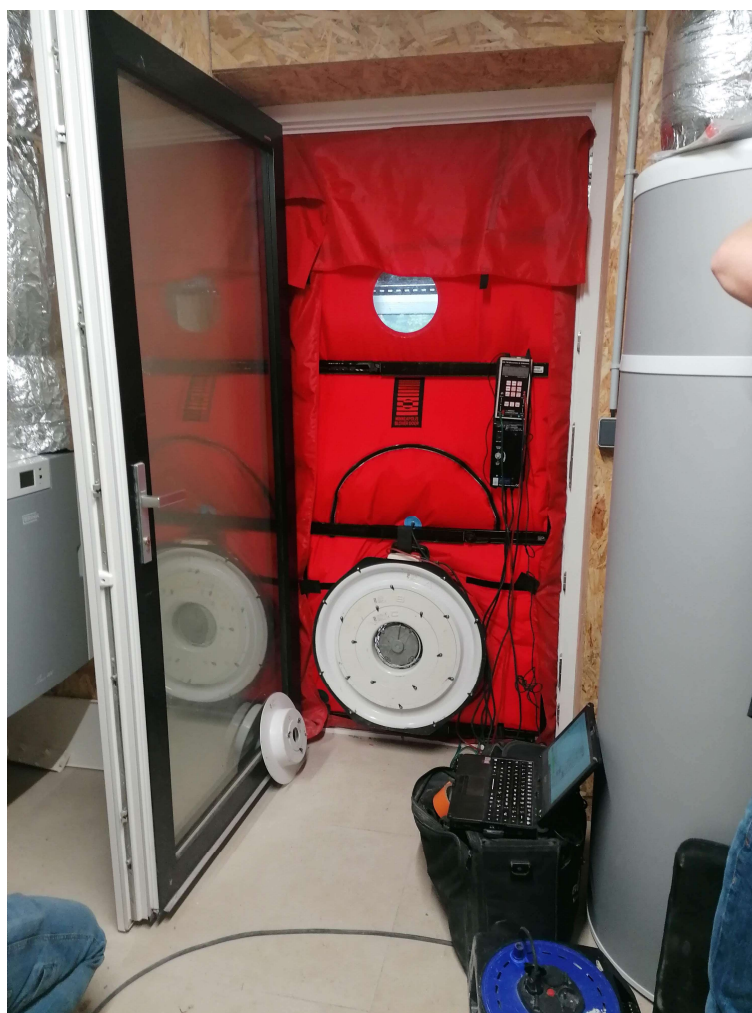
Figure 6 : Test de la "blower door"
