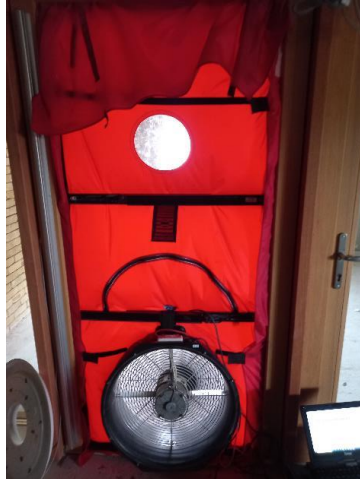
Figure 21: Porte soufflante dans le sas.
