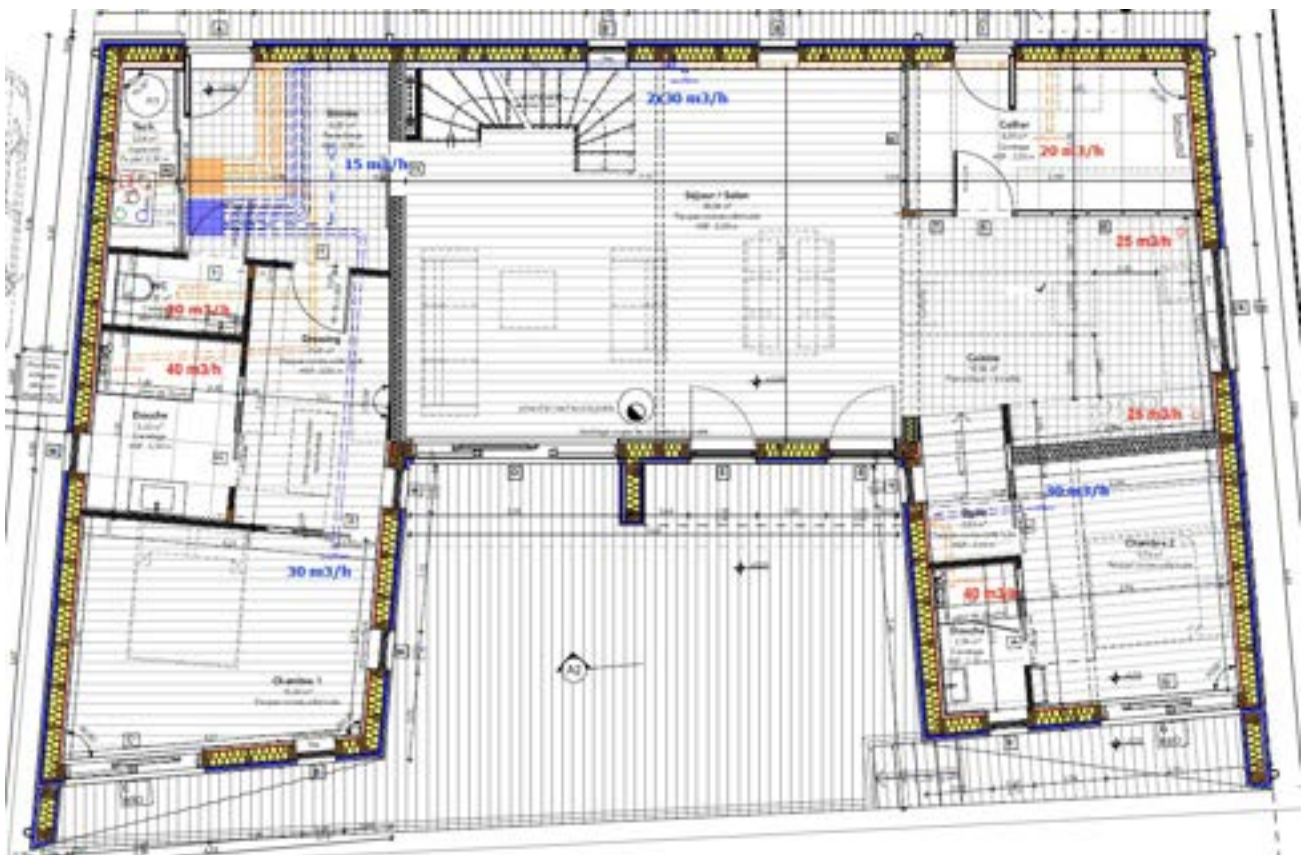
25 : Plan de ventilation RDC
