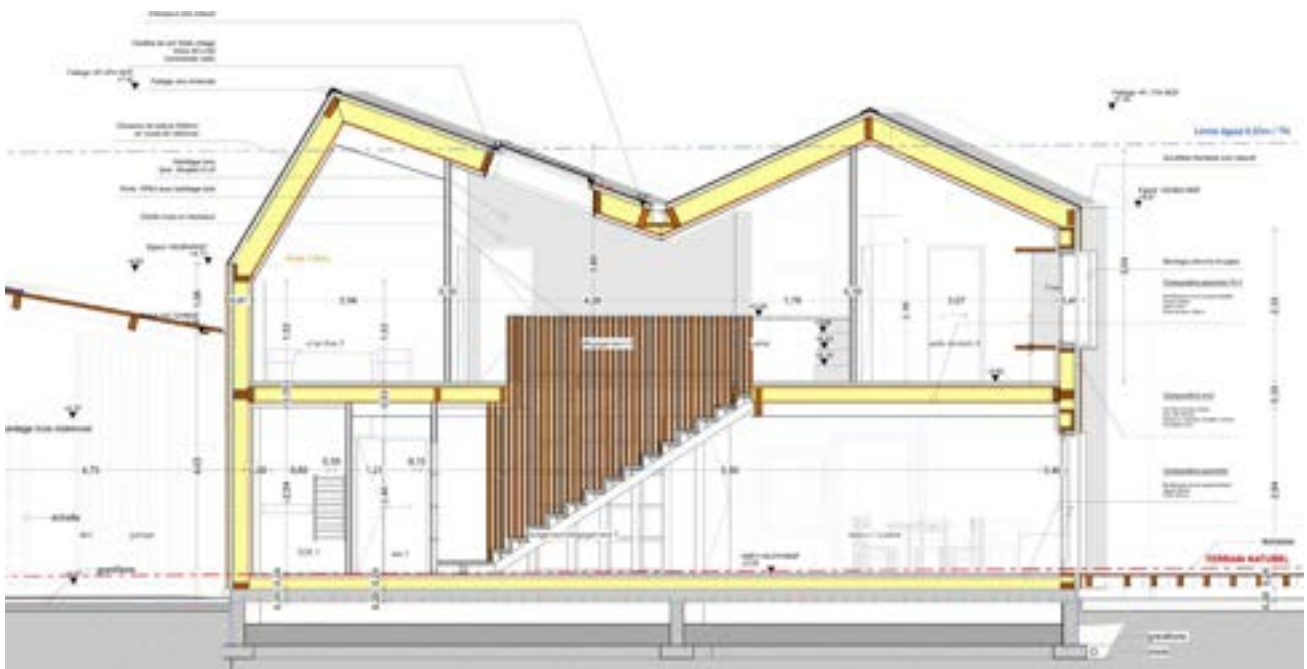
9 : Coupe B2 de Nord-Ouest en Sud-Est : coupe longitudinale sur escalier, fenêtre de toit exposée ouest et terrasse / cheneau en liaison des deux toitures
