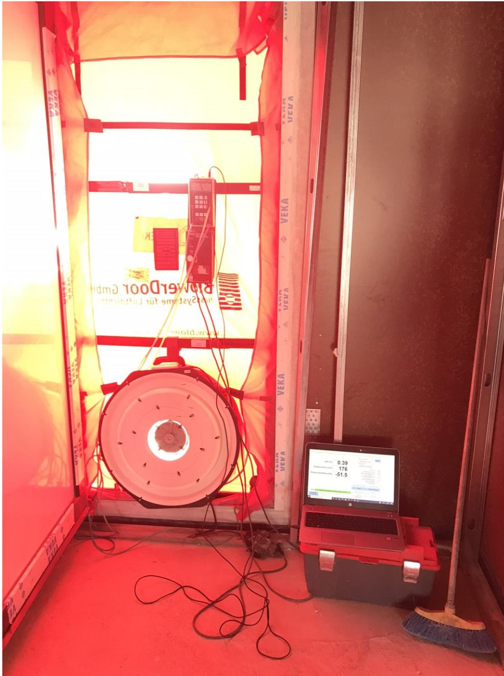
Durante la prueba se revisó toda la envolvente de la vivienda y se pudieron corregir fugas leves que existían en el paso de conductos desde el cuarto de instalaciones y la vivienda y en el sellado de un punto singular del entramado de madera.
