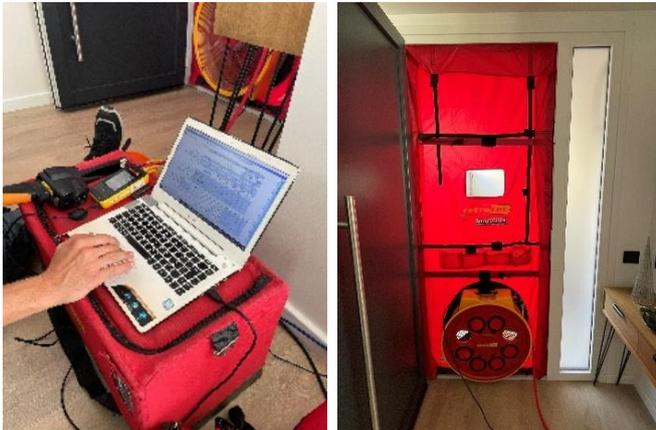
Se realizó una primera prueba de hermeticidad en la fase intermedia de obra, con todas las instalaciones pasadas y los trasdosados interiores abiertos para tener acceso a la capa hermética para detectar y reparar posibles infiltraciones.
