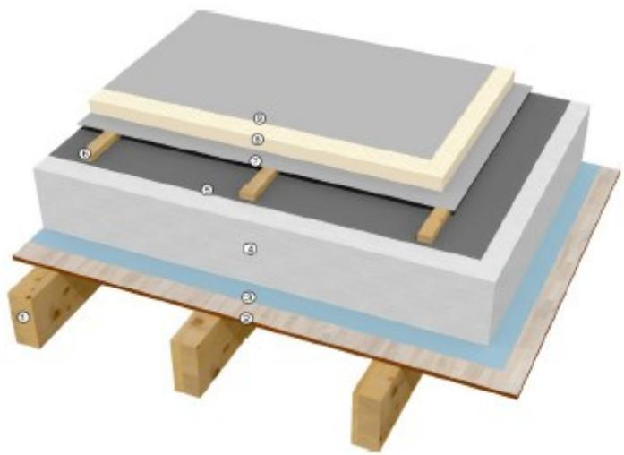
La cubierta se resolvió con la siguiente solución constructiva de exterior a interior: panel sandwich, lana mineral en estructura formación pendiente panel, aislamiento EPS grafito, tablero aglomerado hidrófugo, lámina freno de vapor DA de Proclima, tarima machihembrada de abeto sobre estructura de madera laminada
