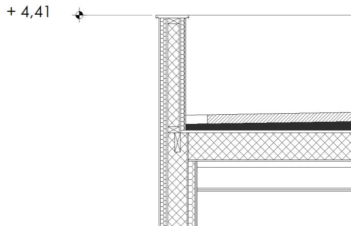
La cubierta de los porches de planta baja se resolvió con panel sandwich sobre estructura de madera laminada.
