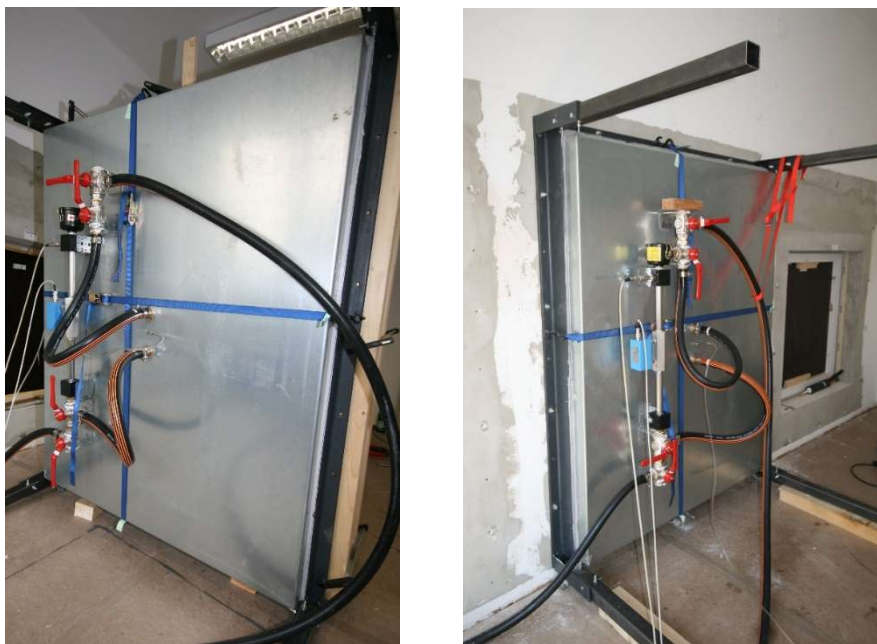
Abbildung 7: Messvorrichtung mit einem Laminarflow-Element montiert an dem Holzwandabschnitt (links) sowie an der Massivwand (rechts).
