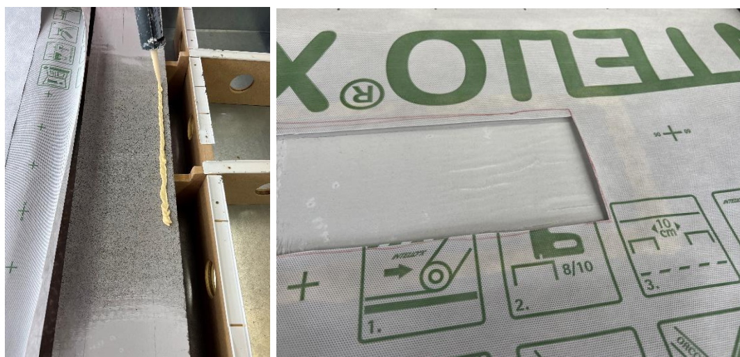
Image 3 : Collage béton / pare-vapeur avec ORCON CLASSIC dans le dispositif de mesure (gauche). Collage béton / pare-vapeur détaillé (droite).
