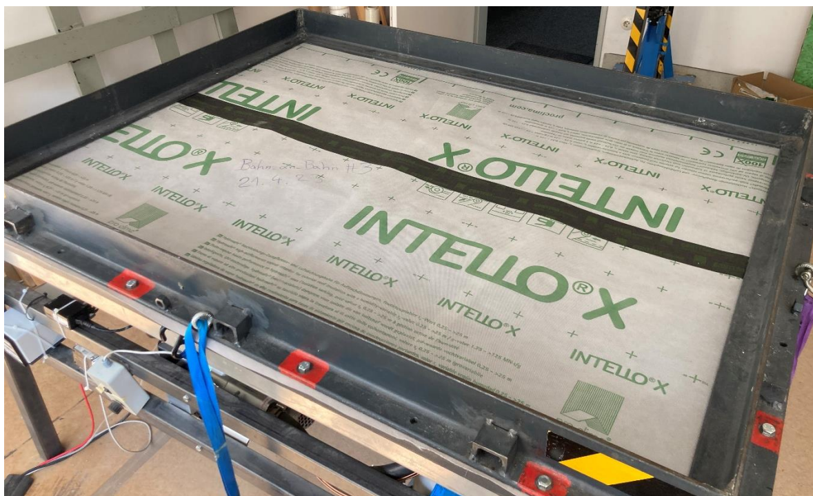
Image 1 : Collage avec la bande adhésive CONTEGA SOLIDO IQ pour le raccord entre bandes pare-vapeur dans le banc de mesure.
