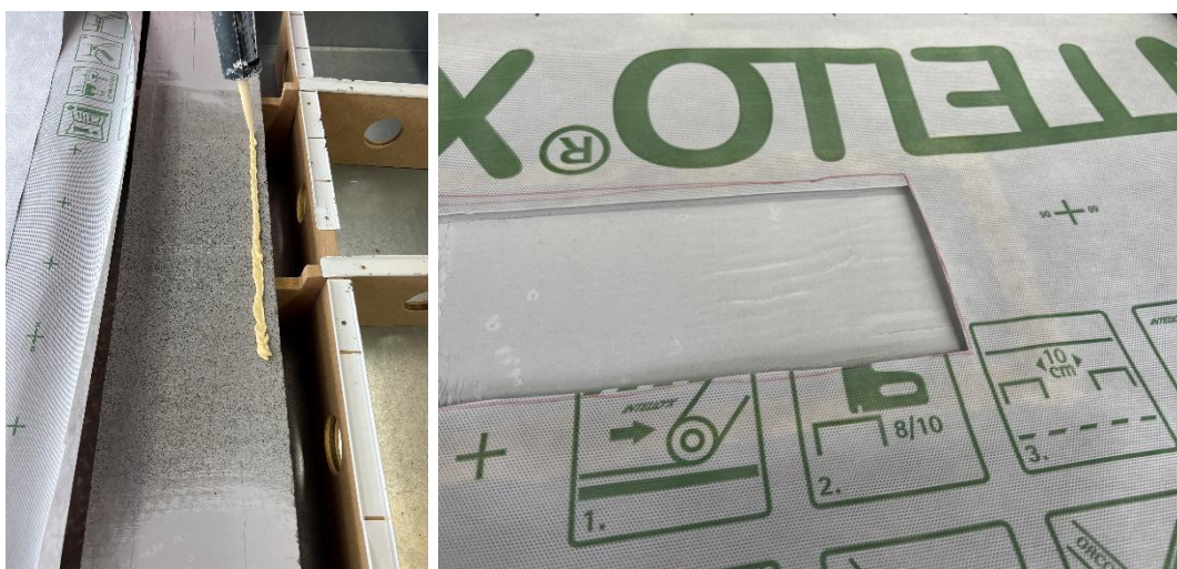
Abbildung 3: Verklebung Beton an Bahn mit ORCON CLASSIC in der Messvorrichtung eingespannt (links). Verklebung Beton an Bahn im Detail (rechts).
