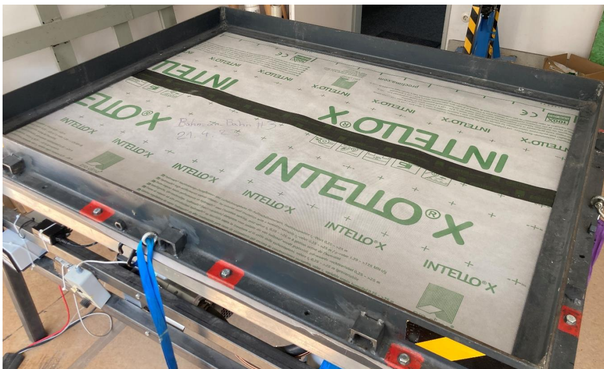
Abbildung 1: Verklebung mit CONTEGA SOLIDO IQ für den Anschluss Bahn an Bahn im Messstand.
