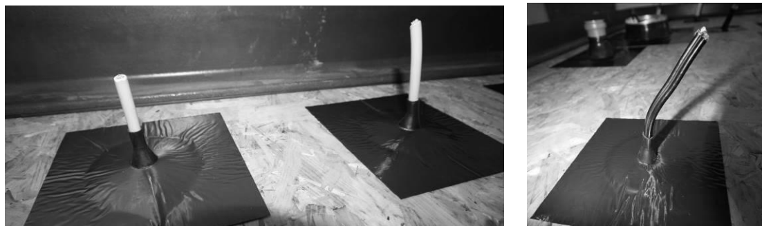
Abbildung 4: Abdichtung der beiden 3x1,5 NYM-Kabel (links), sowie eines Zwillingskabels (rechts) mit KABSEAL GAS 8-12.
