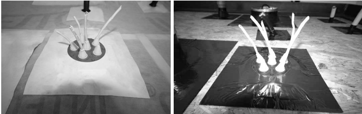
Abbildung 5: Durchführung der fünf Telefonkabel mit der Kabelmanschette KABSEAL PRO 6 4-11 der Serie KABSEAL PRO (links) und mit der Kabelmanschette KABSEAL PRO 6 Alu 4-11 (rechts).
