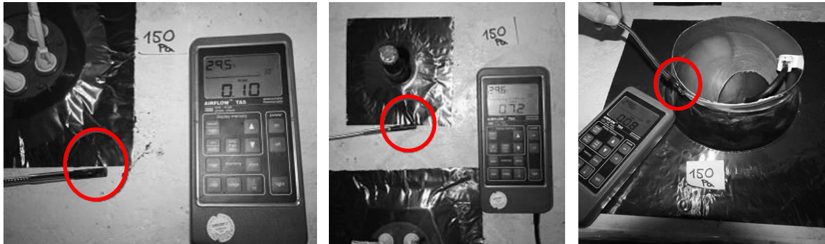
Abbildung 21: Kleine Restleckagen an der KABSEAL PRO 6 ALU 4-11 Manschette (links), der KABSEAL GAS 22-25 Manschette (Mitte) in Verbindung zum Bauteil und an der KABSEAL GAS 180-195 Manschette am Wickelfalz (rechts) bei ungefähr 150 Pa. Die Messung der Luftgeschwindigkeit erfolgt auch hier mit einem Thermoanemometer.
