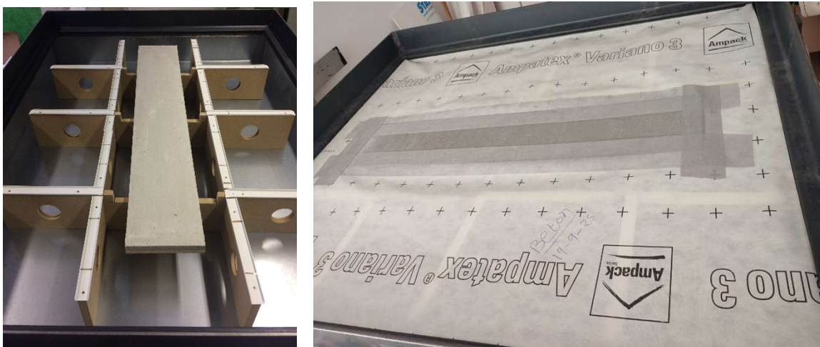
Abbildung 1: Halterung für Platten in der Messvorrichtung mit eingelegter Beton-Platte (links). Die Halterung der Platten dient gleichzeitig zur Unterstützung der Bahn bei Unterdruck. Verklebung Beton an Bahn mit AMPACOLL FENAX (rechts).
