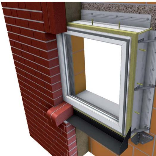
FOPPE® Element-Montage-System bei 2-schaligem Mauerwerk
