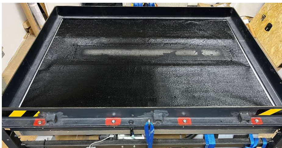
Abbildung 2: Prüfung einer Fugenabdichtung zu einem Betonbauteil
