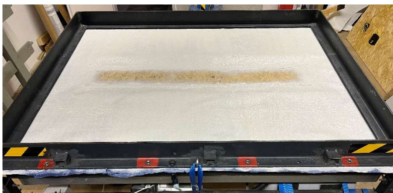
Abbildung 3: Prüfung einer Fugenabdichtung zu einer Holzwerkstoffplatte.
