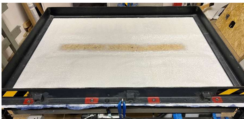
Illustration 3 : Contrôle de l'étanchéité d'un joint avec un panneau en bois.
