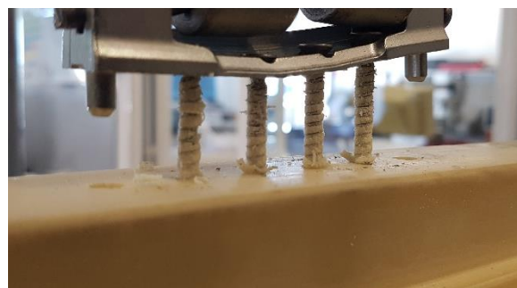
Ensayo de tracción con arrancamiento
