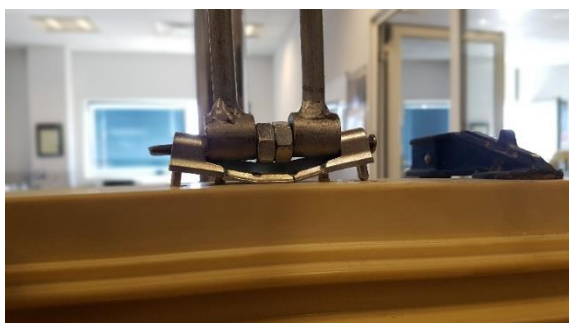
Ensayo de tracción con arrancamiento
