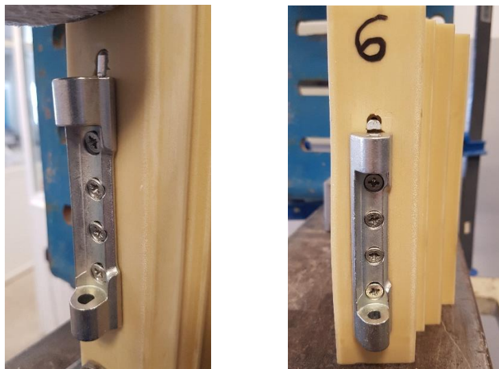
Ensayo de cizalladura con desgarro y rotura del bulón guía
