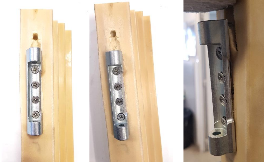
Ensayo de cizalladura con desgarro del perfil
