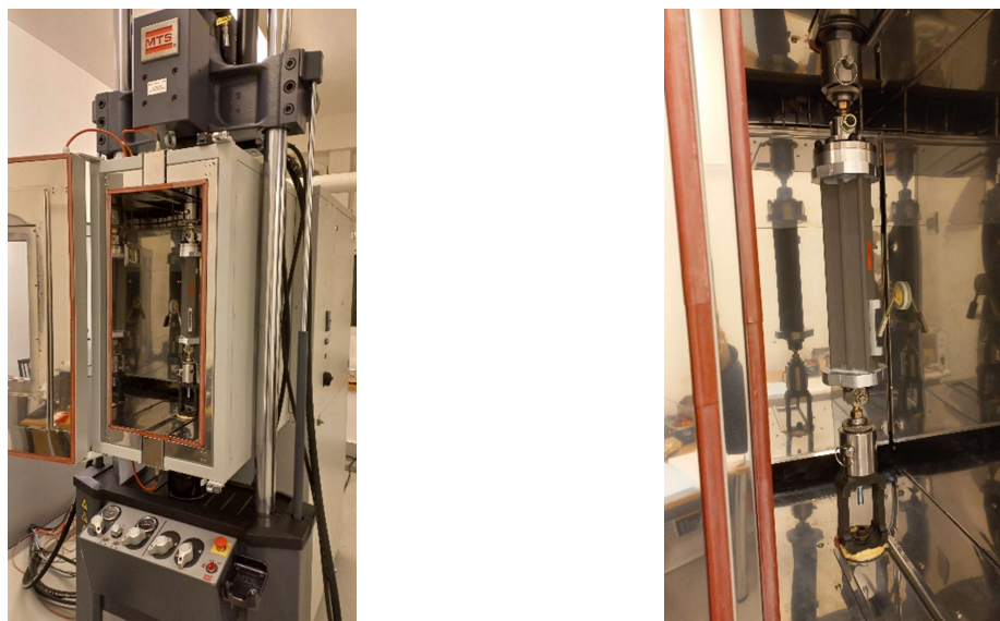
Figura 10 Muestra montada en la máquina MTS
