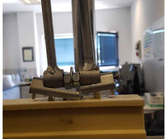
Ensayo de tracción con rotura de la bisagra
