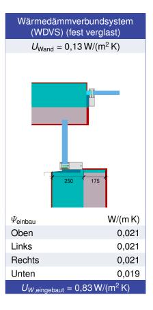
$<sup>^{1}</sup>$ Enthält $\Delta U = 0,17 \text{ W/(m}^{2} \text{ K)}$ . Ermittelt durch 3D-Wärmestromsimulation
