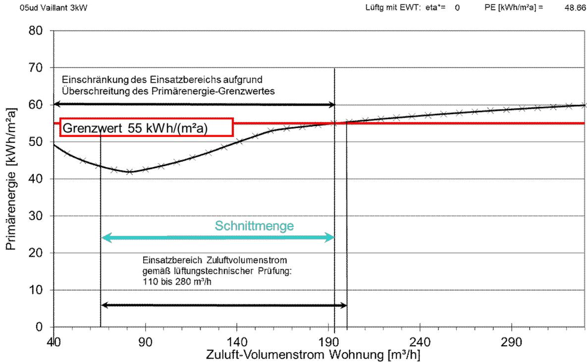
Abbildung 7: Einsatzbereich des 3kW Gerätes 65...192 m<sup>3</sup>/h, Nennvolumenstrom 133 m<sup>3</sup>/h. PE-Kennwert 48.66 kWh/m<sup>2</sup>a als Mittelwert über den Einsatzbereich. Typische Konfiguration des Referenzgebäudes OHNE Erdreich Wärmetauscher (EWT).
