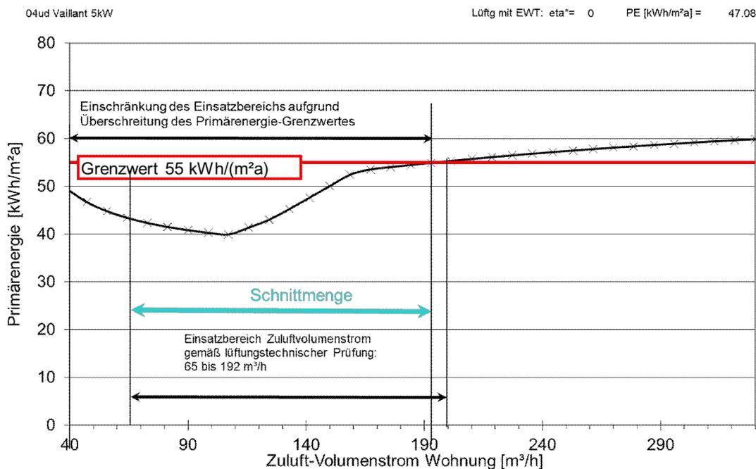
**Abbildung 6: Einsatzbereich des 5kW Gerätes 65...192 m³/h, Nennvolumenstrom 133 m³/h. PE-Kennwert 47.08 kWh/m²a als Mittelwert über den Einsatzbereich. Typische Konfiguration des Referenzgebäudes OHNE Erdreich Wärmetauscher (EWT).**
