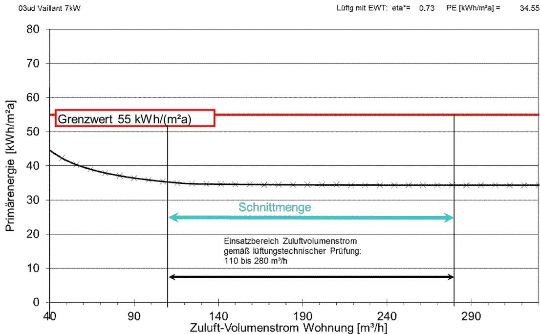
**Abbildung 5: Einsatzbereich des 7kW Gerätes 110...280 m³/h, Nennvolumenstrom 195 m³/h. PE-Kennwert 36.08 kWh/m²a als Mittelwert über den Einsatzbereich. Typische Konfiguration des Referenzgebäudes OHNE Erdreich Wärmetauscher (EWT).**
