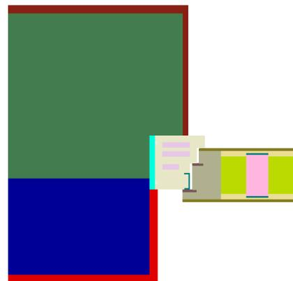
$$\Psi_{\text{einbau}} = 0,01 \text{ W}/(\text{m K})$$
