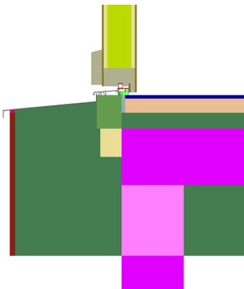
$$\Psi_{\text{einbau}} = 0,08 \text{ W}/(\text{m K})$$
