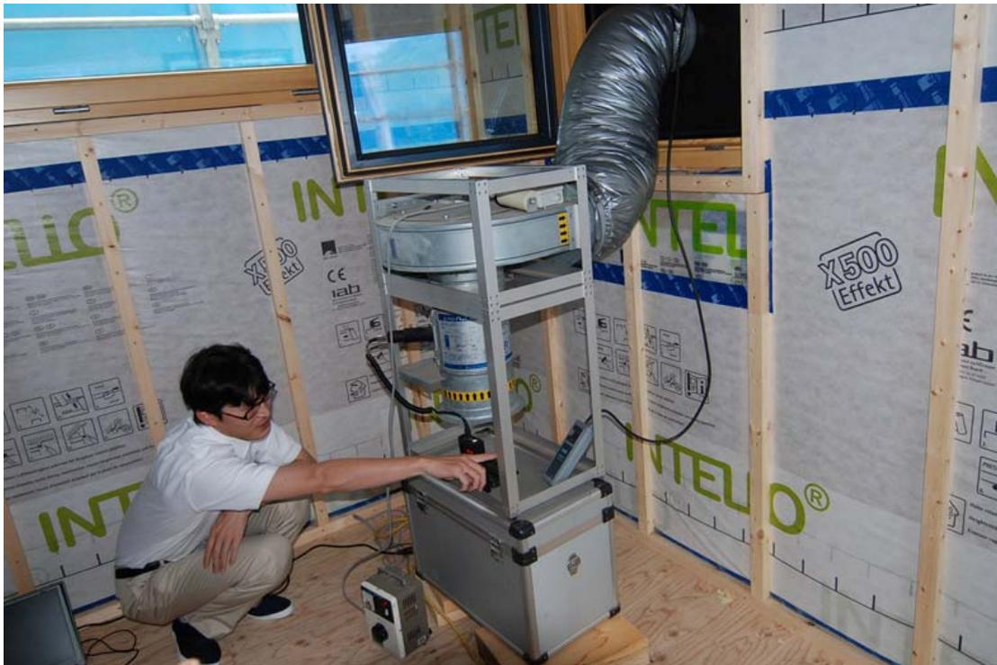
Unterdruck wird während des Blower-Door-Tests erzeugt
