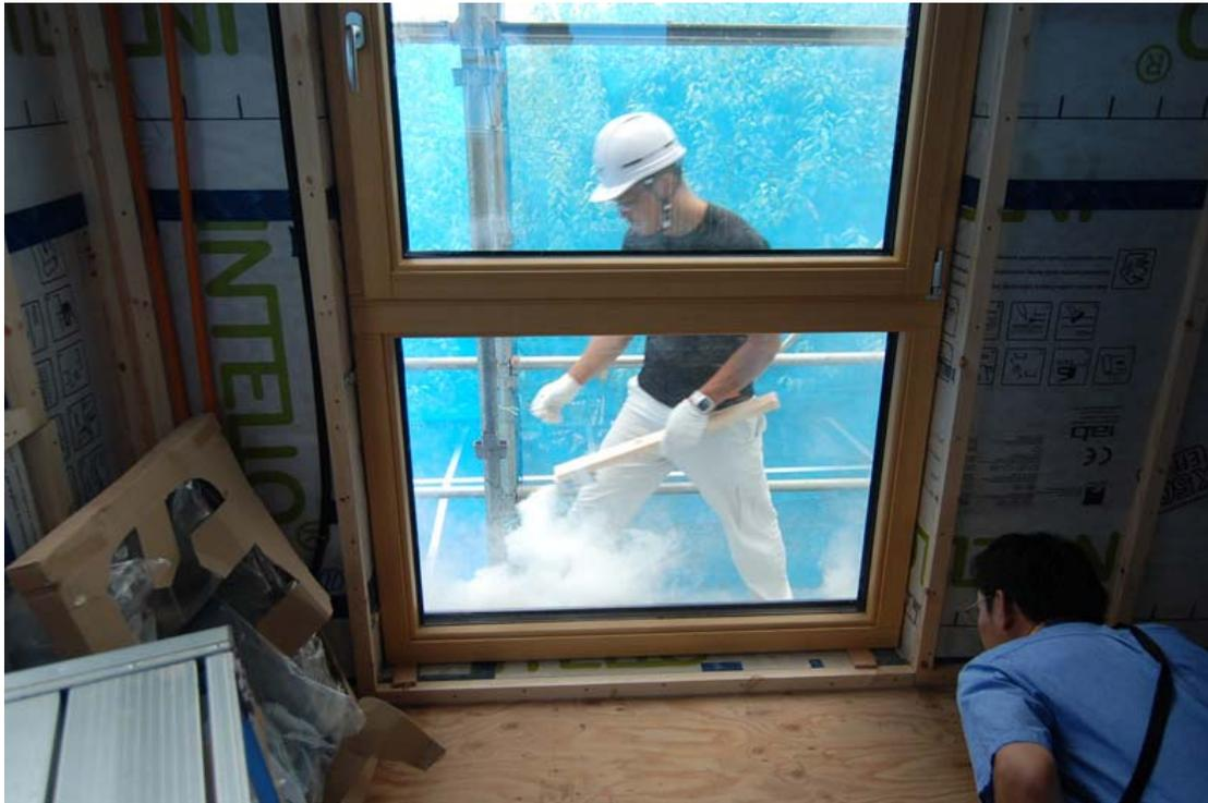
Überprüfung der luftdichten Hülle während des Blower-Door-Tests
