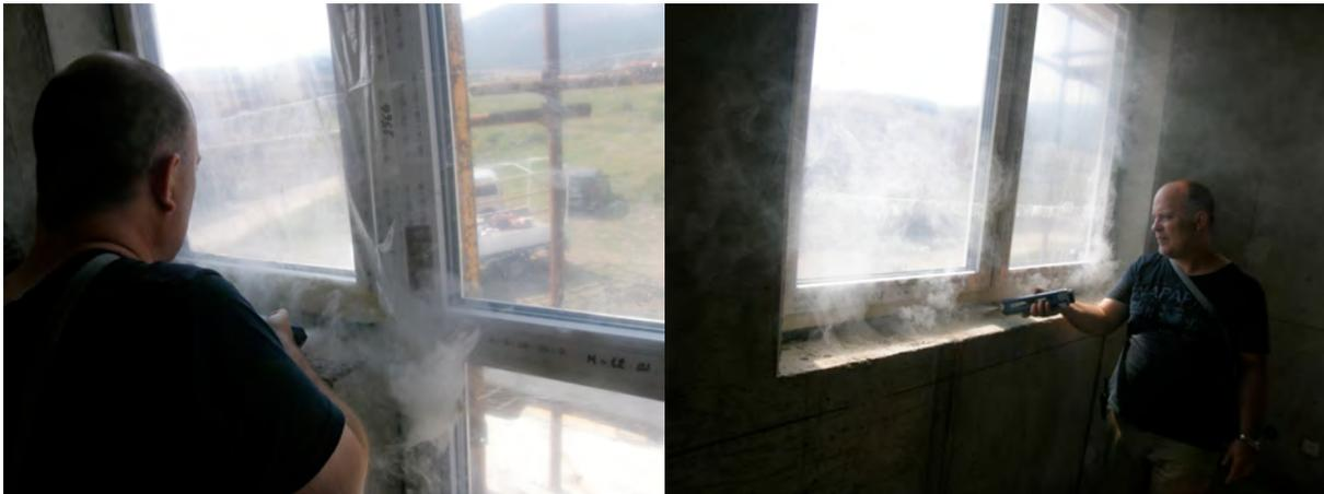
**Fenster:** Die Fenster wurden auf schwarzen Rahmenkasten aus Kunststoff, welcher mechanisch an den Stahlbetonaußenwände gefestigt wurde und zusätzlich mit Silikon abgedichtet wurde, um Luftdichtigkeit sicher zu stellen.
