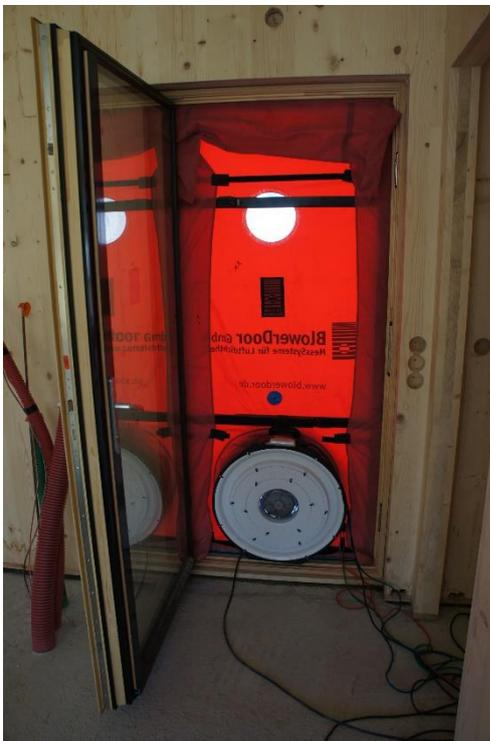
Pour réaliser le test d'étanchéité à l'air sous 50 Pascal de dépression, une porte soufflante BLOWERDOOR<sup>®</sup> a été installée sur la porte d'entrée pour réaliser les mesures du bâtiment.
