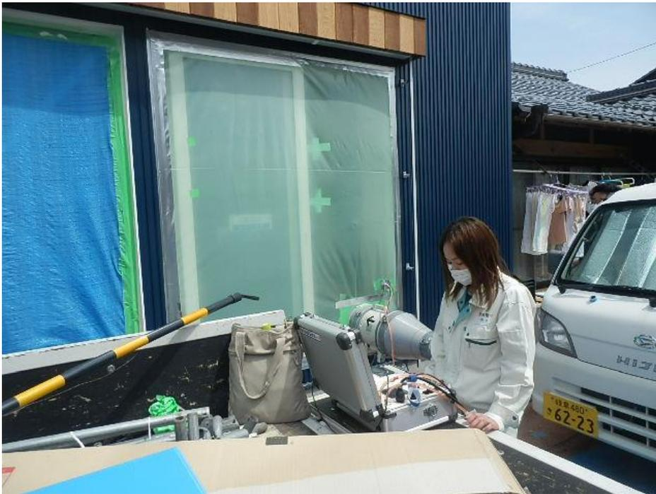
Überdruckmessung : n50 = 0,28/h
