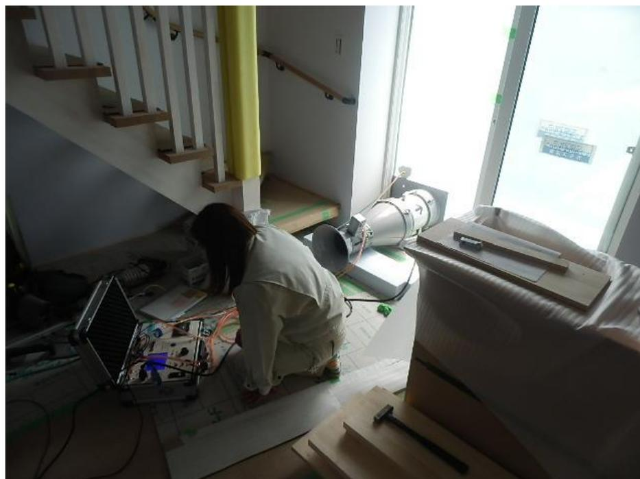
Unterdruckmessung : n50=0.25h
