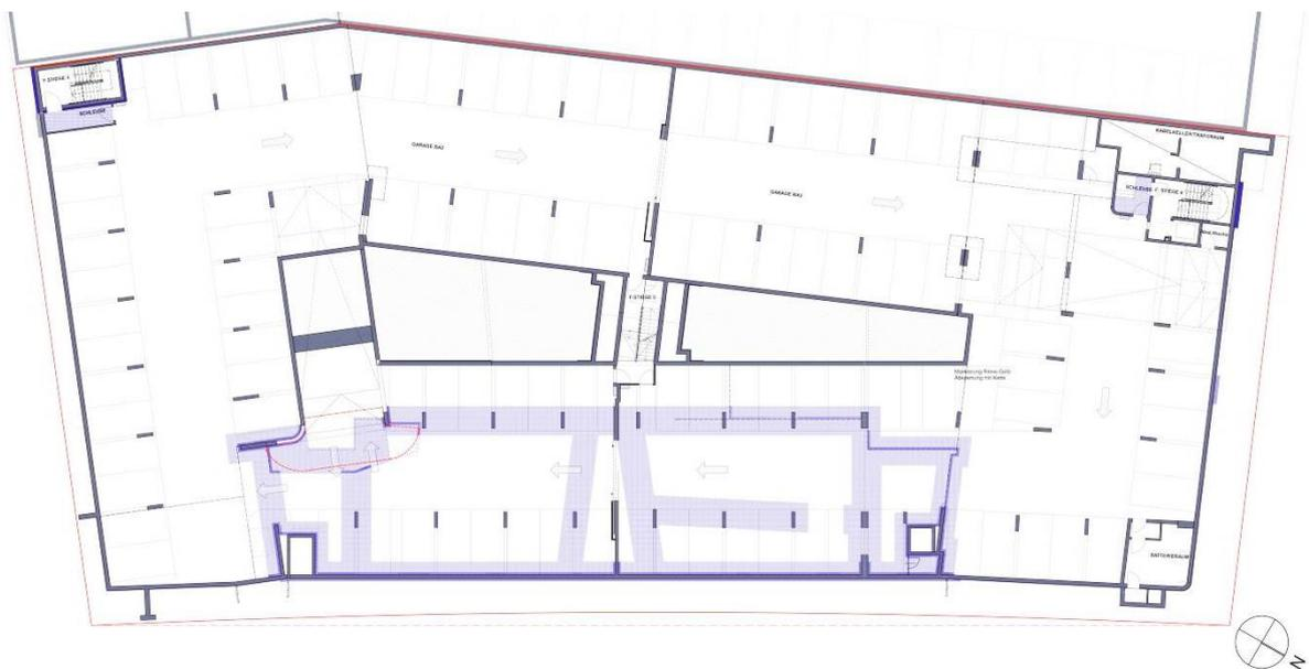
**Studierenden-Wohnheim GreenHouse, Übersichtsplan Flankendämmung 2.Untergeschoss.** Die Dämmungen bei den Fluchtstiegenhäusern und unter dem 1.Untergeschoss Bauteil Luft (mittlerer Bauteil) ist gut ablesbar.
