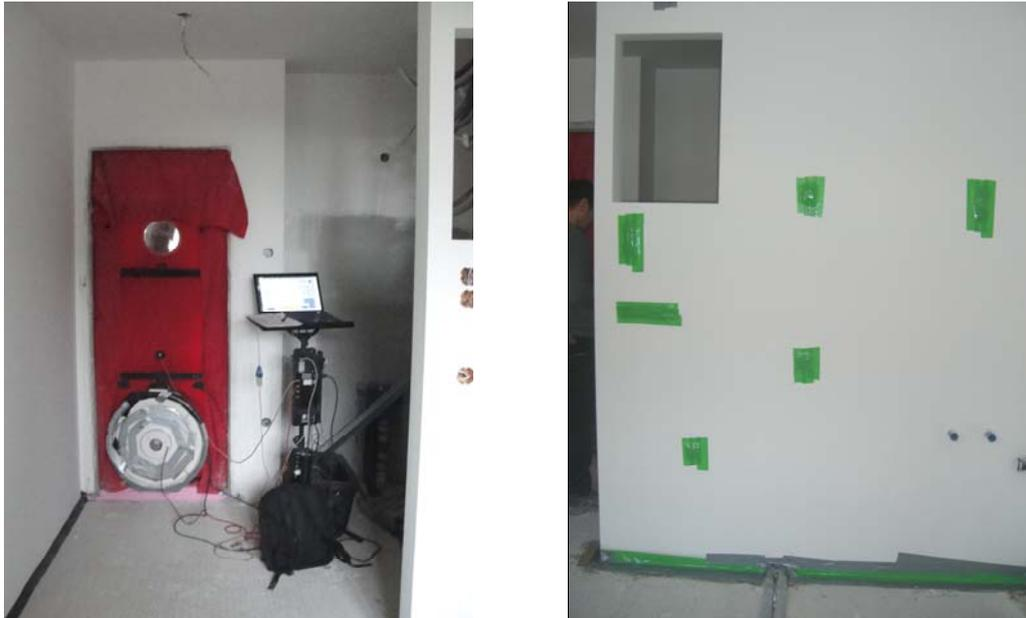
**Studierenden-Wohnheim GreenHouse, Blower Door Test.** Links Messeinrichtung in Zimmereingangstüre eingebaut. Rechts Abklebungen von Innenleckagen zu Messzwecken. (Fotos: aap.architekten).
