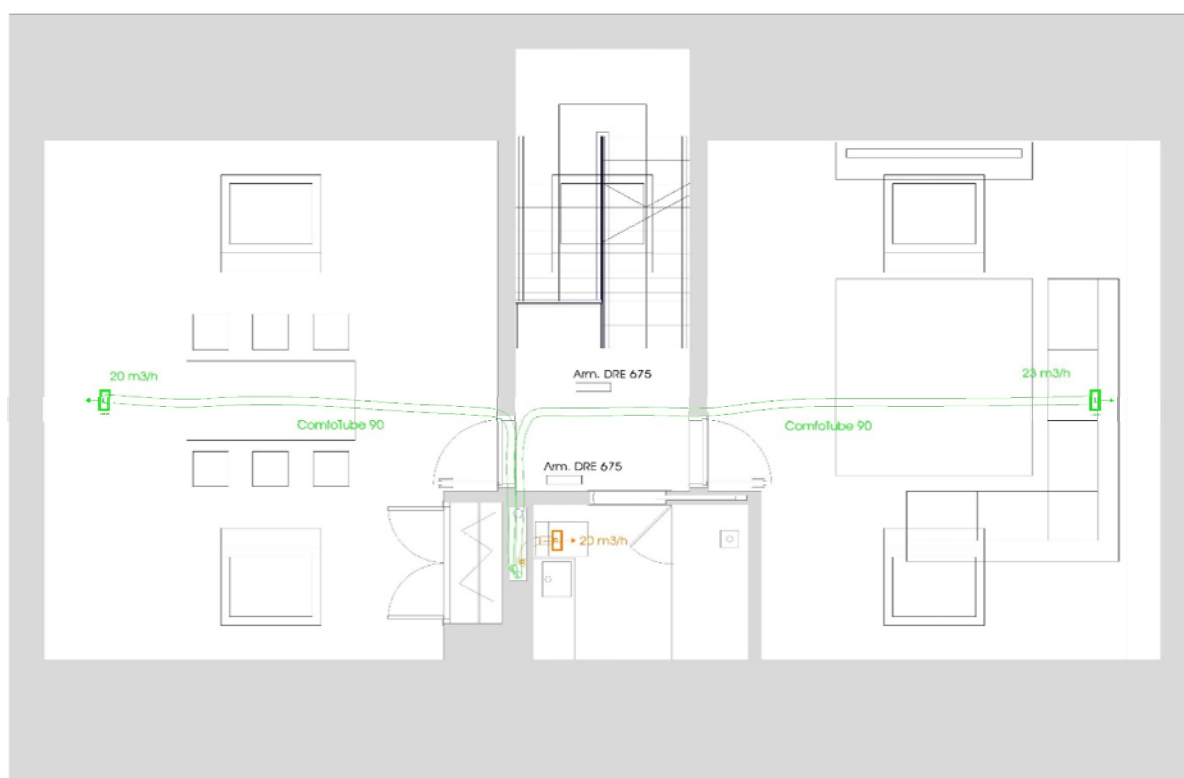
2 nd Floor Ventilation / Ventilación de Planta Segunda
