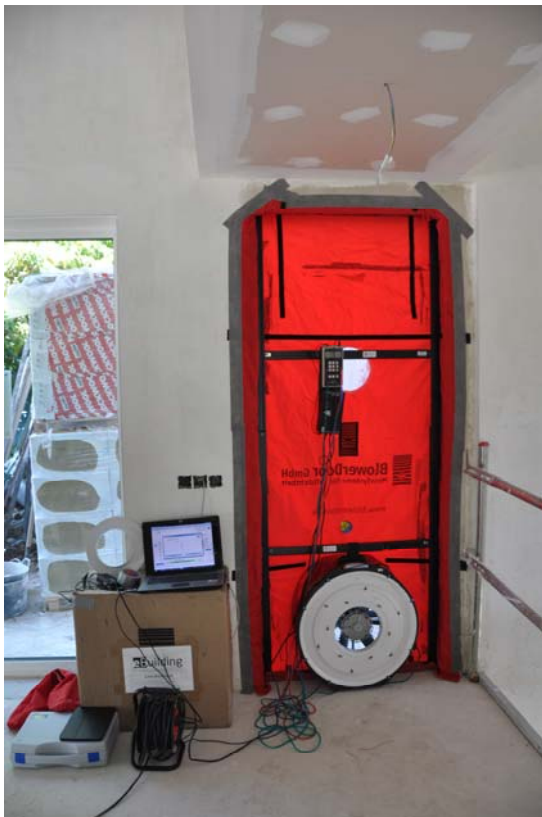
Final Blower Door test n^{50}=0,44 1/h
