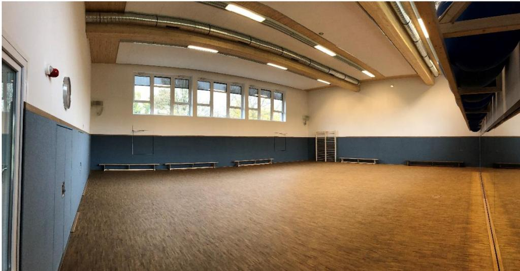
Blick in den Sportraum. Hinten links befinden sich die Nachtluftklappen, die sich gleichzeitig mit den 12 Kippflügeln der oberen Fenster öffnen lassen. Sie öffnen sich nachts nach innen und schließen über Präsenzmelder, um Unfallgefahr zu vermeiden.
