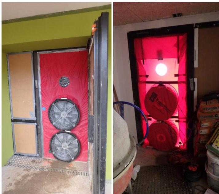
Photos lors du test d'étanchéité à l'air
