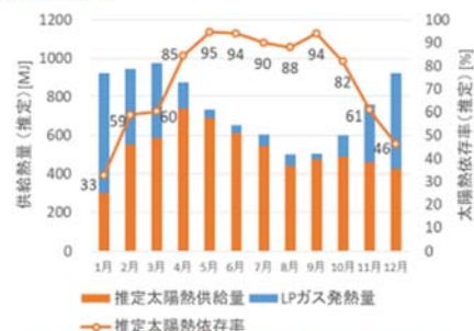
図 11 太陽熱供給量と太陽熱依存率 (推定)
