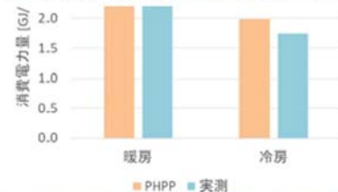
図 12 冷暖房消費量の PHPP 結果と実測の比較
