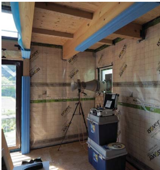
壁の気密層、気密測定時の状況
