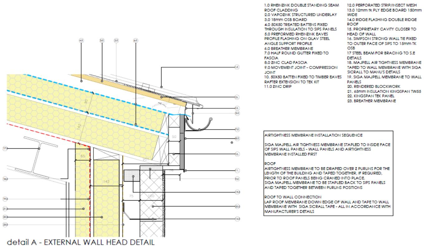
**AIRTIGHTNESS MEMBRANE INSTALLATION SEQUENCE**
