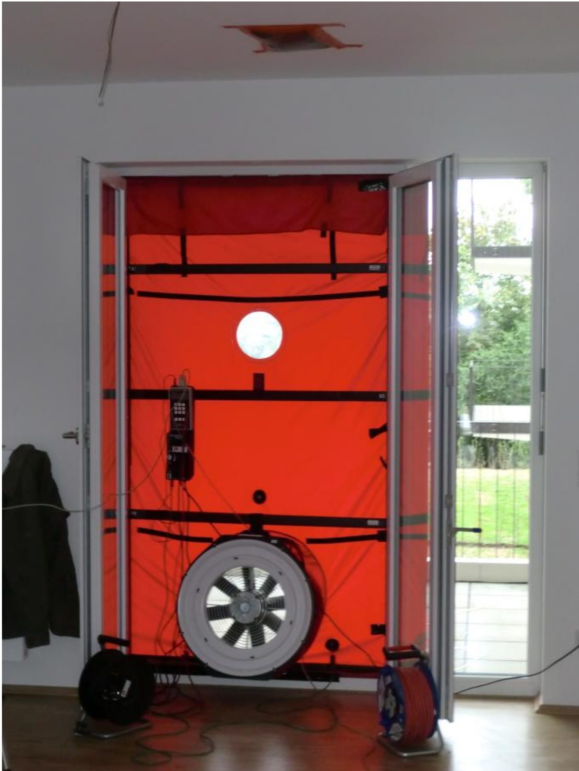
Messung der Luftdichtheit der Gebäudehülle durch das Ingenieurbüro TOHR Bauphysik
