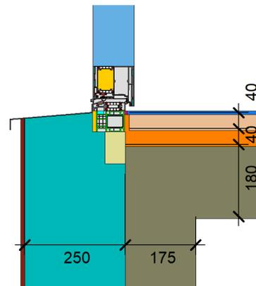
$$\Psi_{\text{einbau}} = 0,08 \text{ W/(m K)}$$
