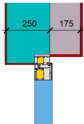
$$\Psi_{\text{einbau}} = 0,02 \text{ W/(m K)}$$
