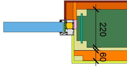
$$\Psi_{\text{einbau}} = 0,02 \text{ W/(m K)}$$
