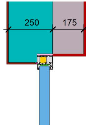
$$\Psi_{\text{einbau}} = 0,02 \text{ W/(m K)}$$
