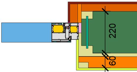
$$\Psi_{\text{einbau}} = 0,02 \text{ W/(m K)}$$
