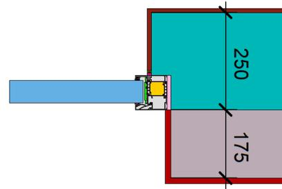
$$\Psi_{\text{einbau}} = 0,02 \text{ W}/(\text{m K})$$
