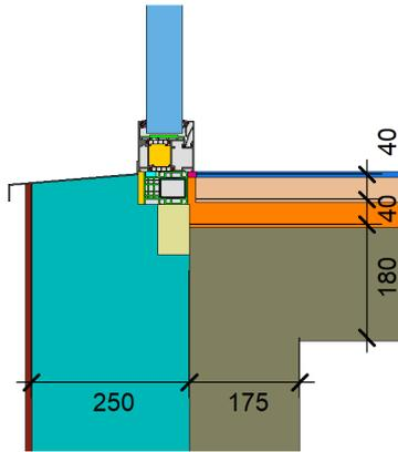
$$\Psi_{\text{einbau}} = 0,07 \text{ W}/(\text{m K})$$
