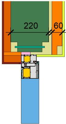
$$\Psi_{\text{einbau}} = 0,02 \text{ W/(m K)}$$
