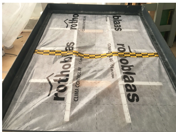
Abbildung 1: Prüfaufbau Flächenabdichtung. Links Fall 1 (Tabelle 2), rechts Fall 3 (Tabelle 2), musterhaft
