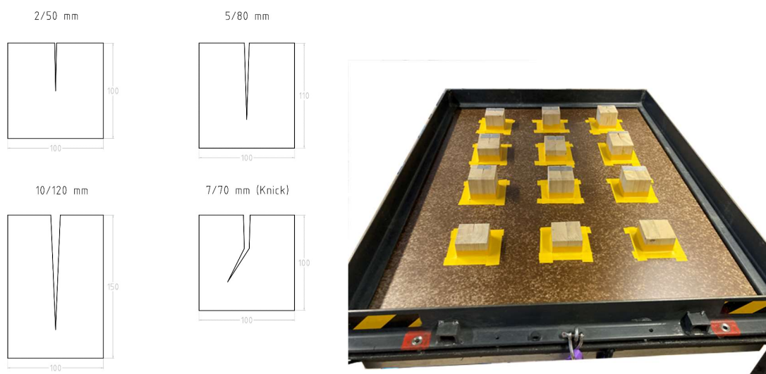
Abbildung 4 links: Probekörper mit unterschiedlichen Riss-Geometrien. Abbildung 4 rechts: Prüfaufbau Holzbalken, musterhaft
