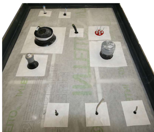
Bild 3: Prüfaufbau Durchdringungen, musterhaft
